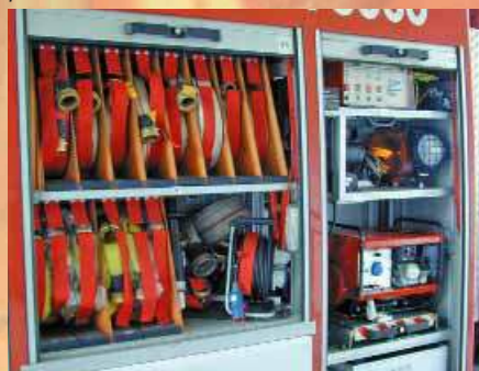
le manichette antincendio necessarie a far arrivare l'acqua dove occorre
